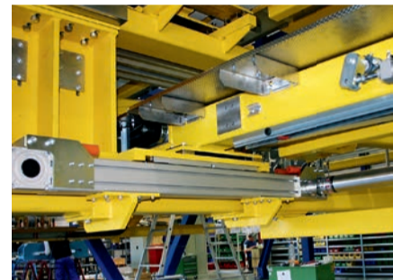
2台のINAリニアアクチュエータMKUSE-25のうち1台が組み込まれた、偏心ヨークシート用リニア搬送システムの横軸調整ユニット
