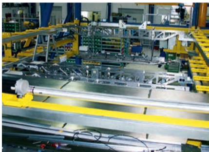
9台のINAリニアおよびタンデムアクチュエータを含む、Tuboly-Astronic AGの変圧器シートメタルハンドリングおよびポジショニングシステムの内部
