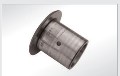
摩擦で磨かれ、それに続く損傷としてローラーの端部で素材疲労を起こした摩擦の例
